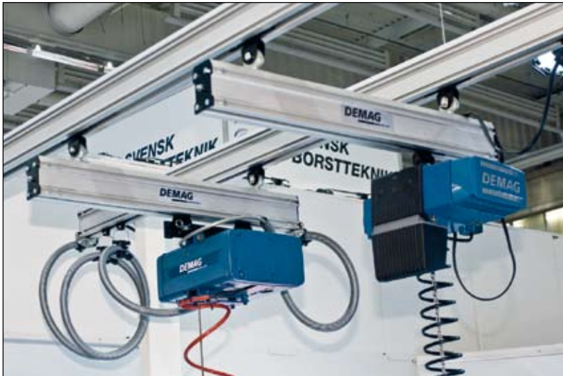
Flera mässbesökare blev intresserade av KBK Aluline (med skenprofiler av aluminium). De lämpar sig för såväl en- och tvåbalkstraverser som raka telferbanor.
