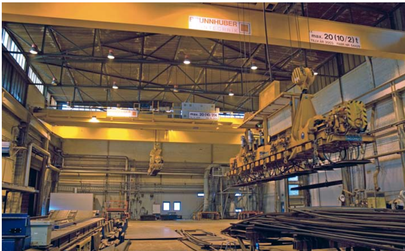
Skeppet där de två Brunnhuber-kranarna sitter är ca 80 meter långt.
