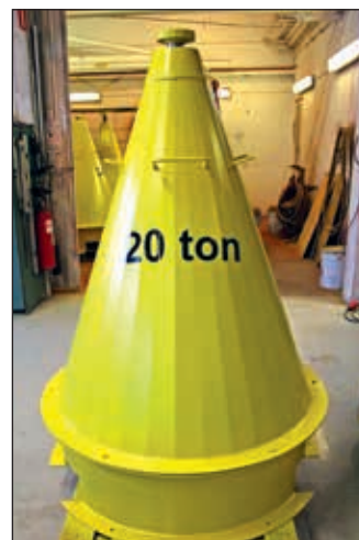
Pallbockar att ställa lok på vid montering. Ett exempel på specialkonstruktion utförd av Dematek i Strängnäs.
