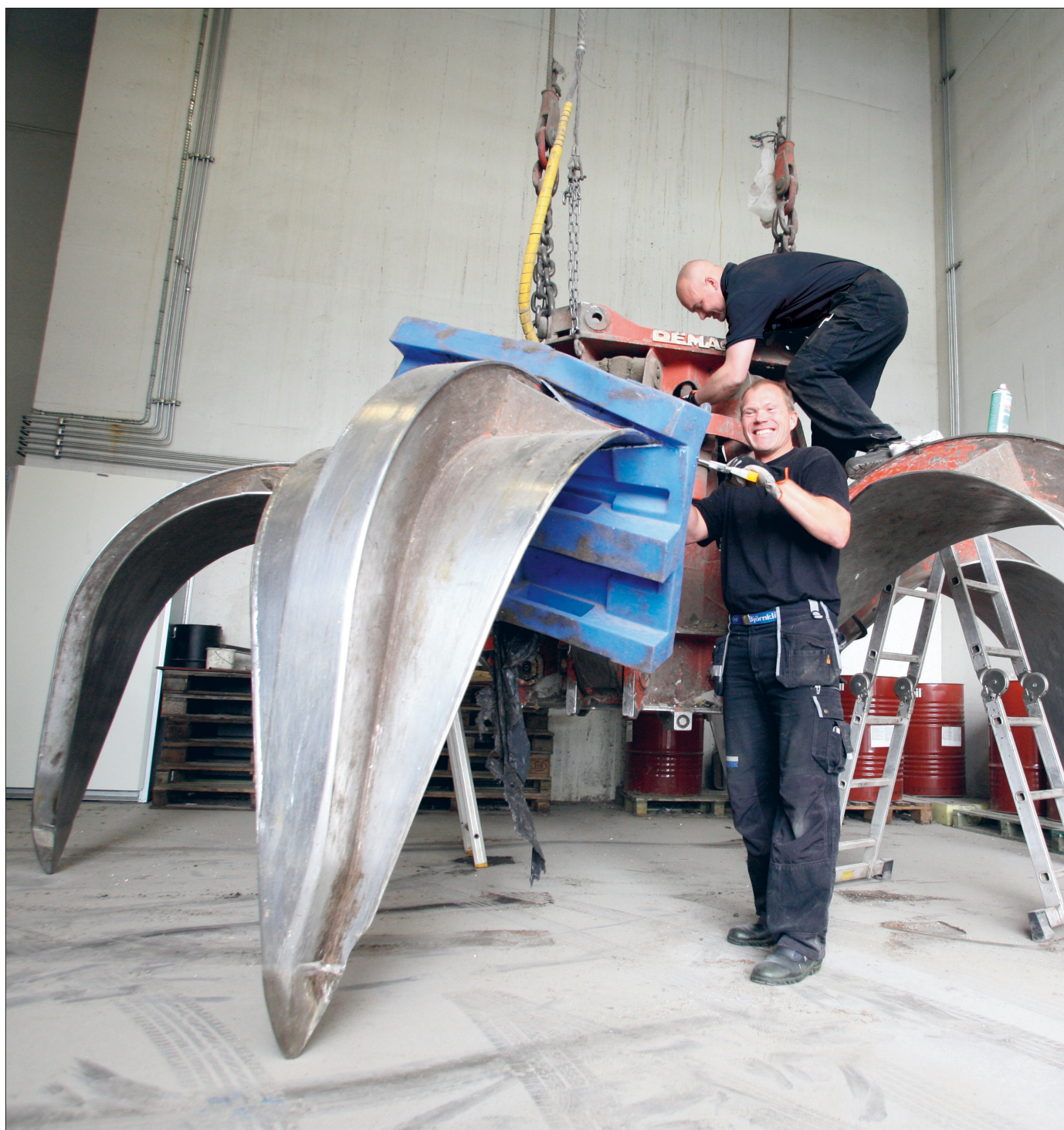
Patrik Lavéno och Michel Höglund från Dematek utför förebyggande service på en av gripskoprna.
