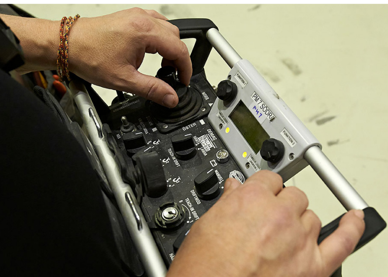
De stora processkranarna manövreras smidigt med radiostyrning.
