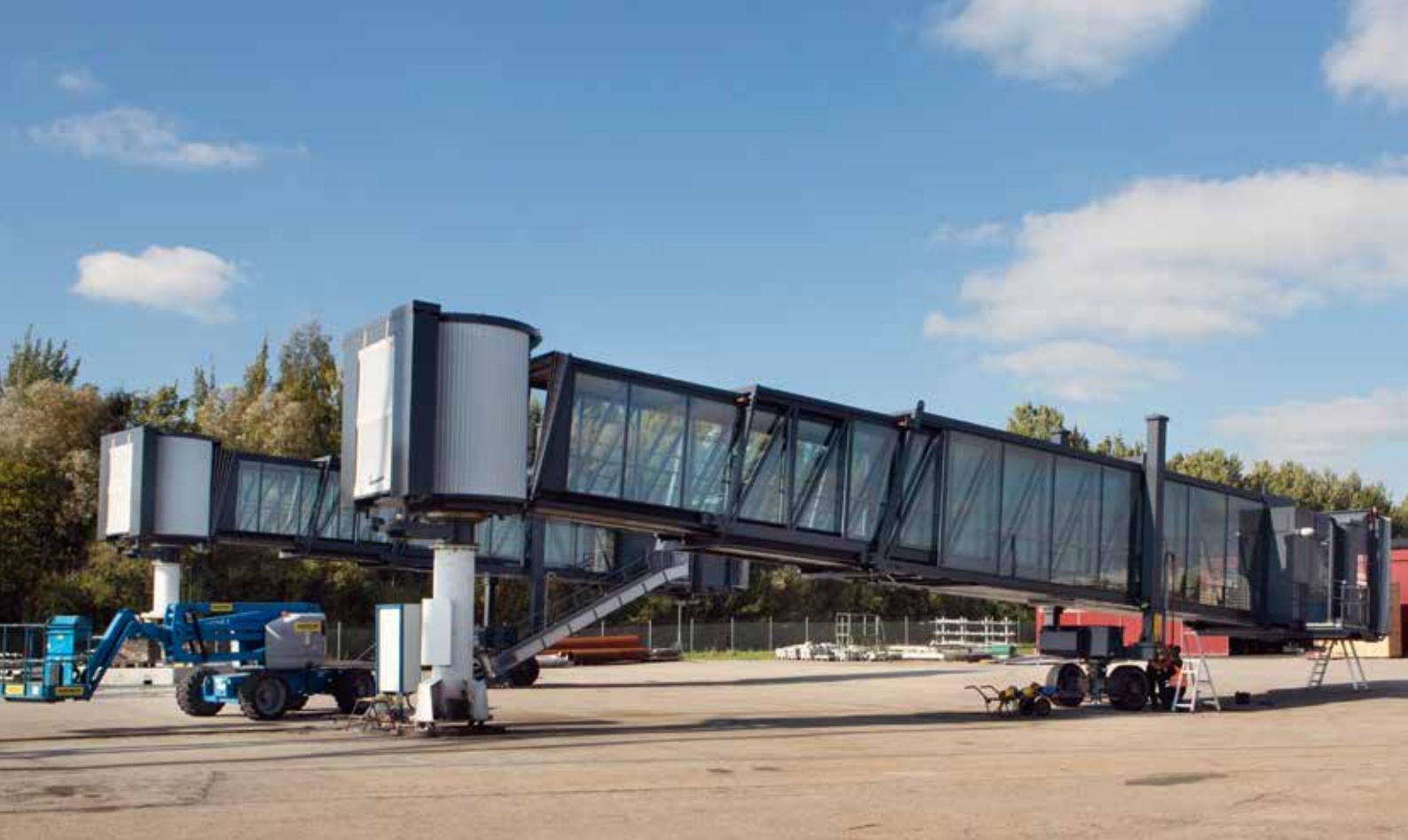
En boardingbrygga är mellan 30 och 50 meter lång och kan väga 30 till 35 ton.
