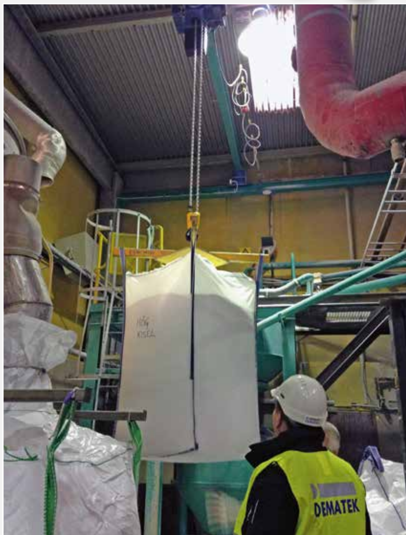
Telfern lyfter säckar på mellan 1 000–1 150 kilo fyllda med aluminiumfluorid.
