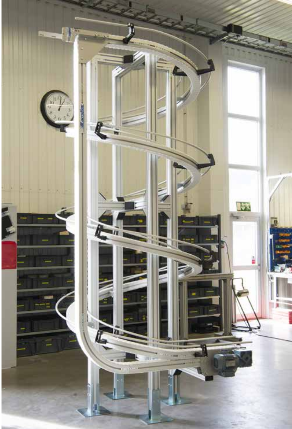
Exempel på Carrylines transportörsystem. Delarna till plastkedjorna formsprutas i företagets platsprutor.
