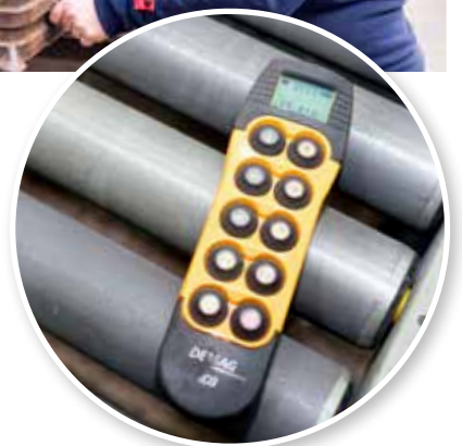
Den nya traversen används för att smidigt och säkert kunna hantera och förflytta gjutformar.
