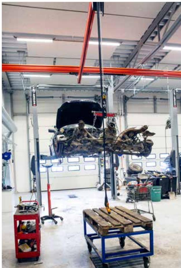
Lyftlösningen bestod av ett KBK Lättlastsystem om 18 x 8 meter och tre st 500 kg telfrar.
