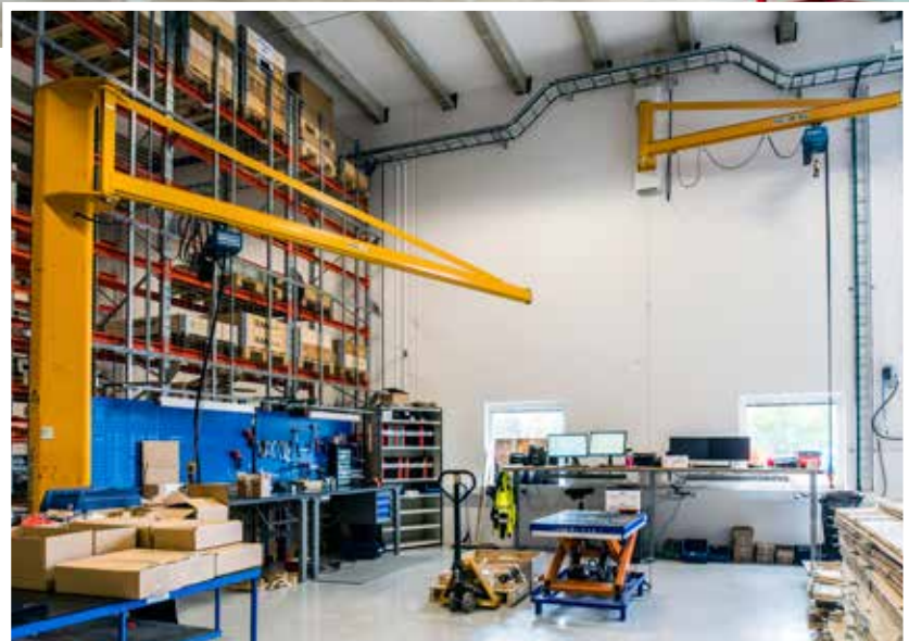
OilQuicks anläggningar är utrustade med bland annat KBK lättlastsystem och svängkranar från Dematek.
