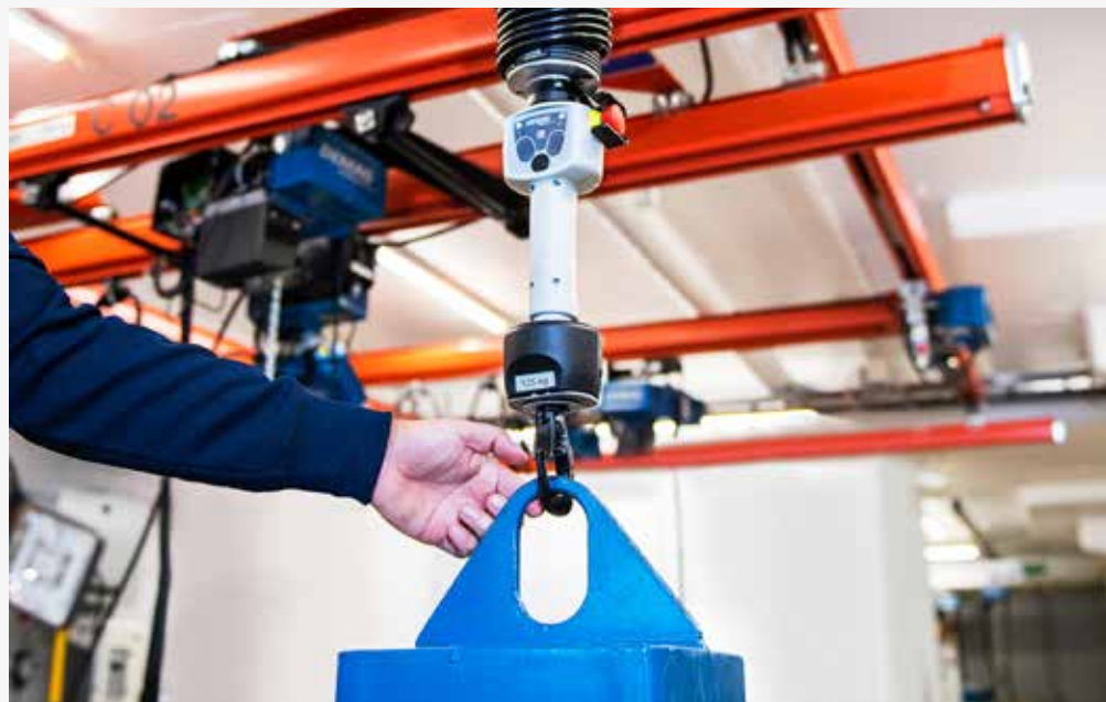
Med Demag Balancer DCBS får man en ergonomisk lyftlösning som innebär lyft och montage med millimeterprecision.
